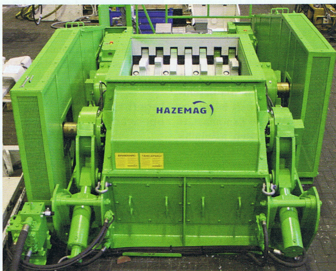
Der Walzenbrecher zerkleinert das Grobgut auf die gewünschte Korngrösse von 0 bis 125 mm.
